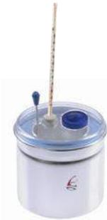
**7 шаг.** Как только вы измерили температуру горячей воды осторожно влейте в калориметр холодную воду из стакана. Перемешайте смесь, дождитесь теплового равновесия и измерьте температуру полученной смеси ( $t$ ). Результат прямого измерения запишите в таблицу № 1 с учетом абсолютной погрешности ( $\Delta t$ ), равной цене деления шкалы термометра.
