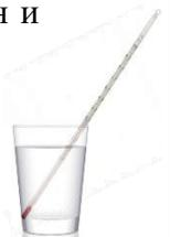
**6 шаг.** Отмерьте мензуркой **100 мл** горячей воды и перелейте во внутренний стакан калориметра. Вставьте термометр, дождитесь теплового равновесия и измерьте температуру горячей воды ( $t_2$ ). Результат прямого измерения запишите в таблицу № 1 с учетом абсолютной погрешности ( $\Delta t$ ), равной цене деления шкалы термометра.
